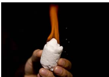
Figure 1 - Hydrate de gaz en combustion Photo offerte par le Conseil national de recherches Canada.
